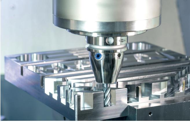
Mit der dritten Generation des OptiMill-Uni-HPC kombiniert MAPAL die Anforderungen Stabilität, Verschleißfestigkeit und Flexibilität mit der höheren Zähigkeit eines neu entwickelten Schneidstoffs (Bild: ©MAPAL)
