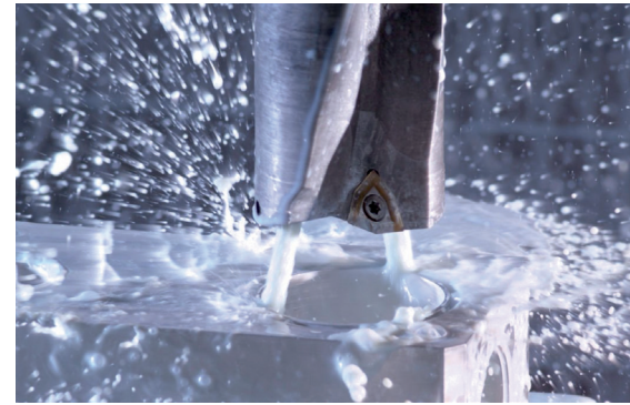
Adaptive Steuerung des Kühlmitteldrucks (Bild: IFW)
